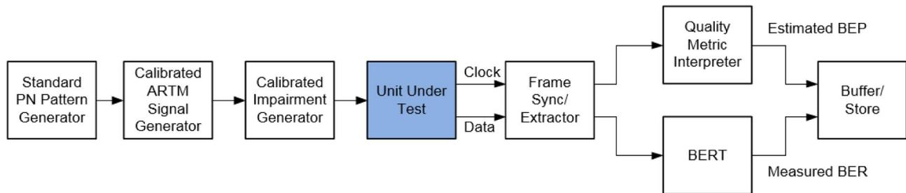
Figure 8 - DQM Calibration Fixture.
